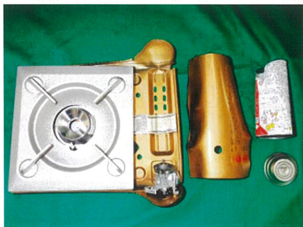
🔥 ガスボンベが破裂したこんろ 🔥
