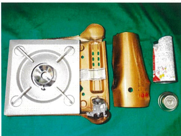
🔥 ガスボンベが破裂したこんろ 🔥
