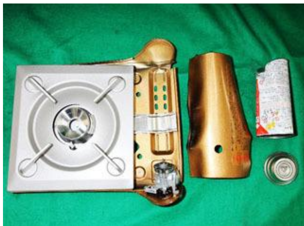
🔥 ガスボンベが破裂したこんろ 🔥
